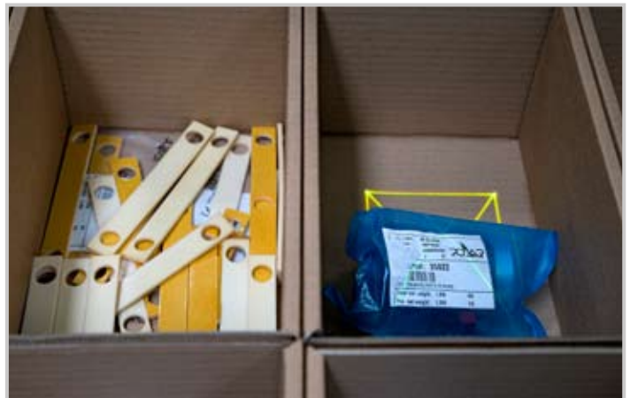
FACHANZEIGE IN EINEM TABLAR MITTELS PICK-BY-LIGHT-SYSTEM
