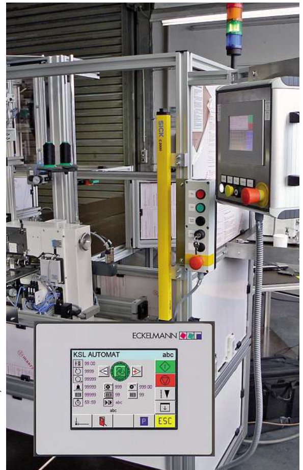
Bild 2: Bedienteil der Doppelkopfnähmaschine. Für die Bedienkonsolen wird die NFI-(Near-Field-Imaging-)Touch-Technik verwendet, wodurch auch eine Bedienung mit Handschuhen möglich ist.
