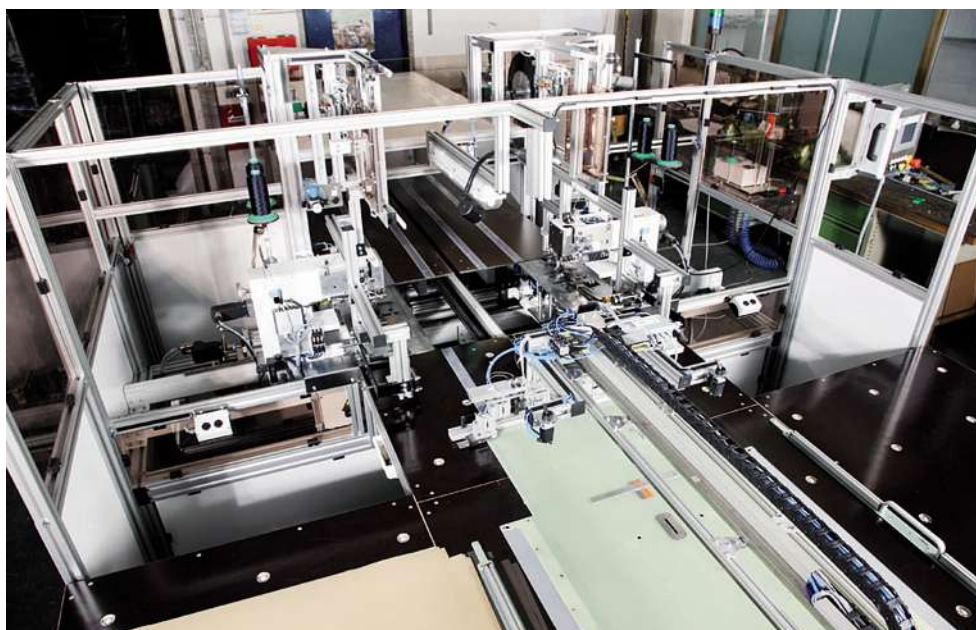
Bild 1: Diese Doppelkopfnähmaschine näht synchron Metallbänder an den Seiten von Sonnenschutzrollos ein.
