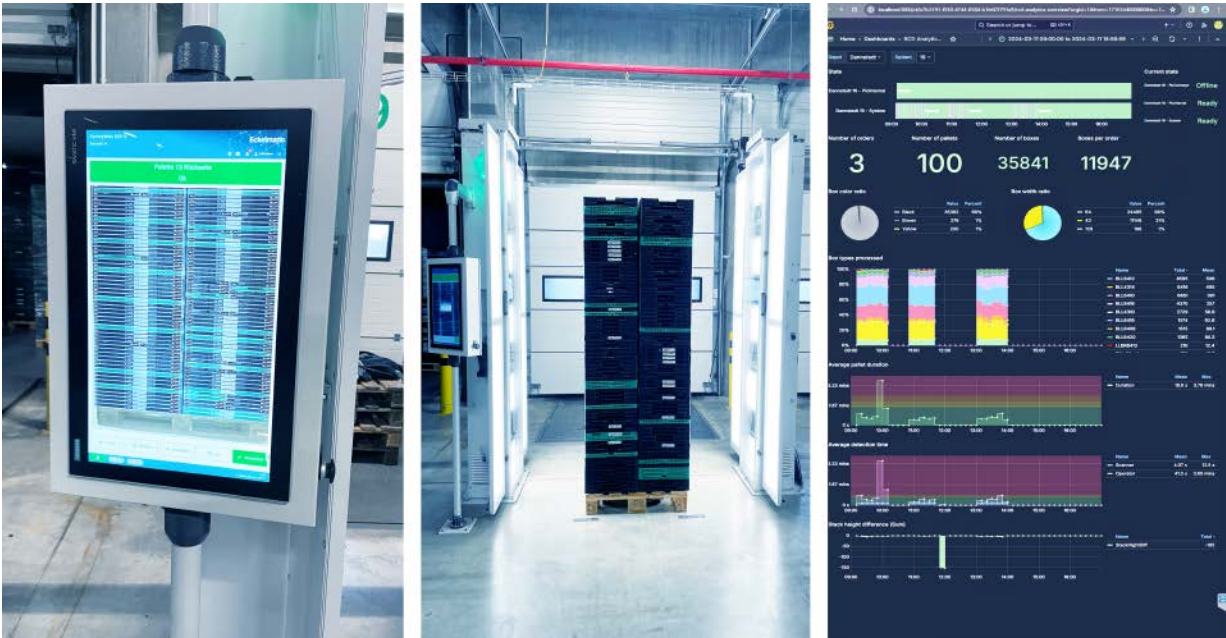
➤ Eckelmann lieferte Säulenpaare zur automatisierten Massenerfassung und -zählung von RPCs in Pfand-Mehrwegsystemen: sie identifizieren die RPCs auch – defekte und Fremdgebinde werden aussortiert.
