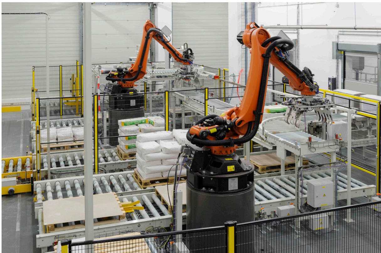
Abb. 1: Robotergestützte Palettierung eines Verpackungsbereiches mit mehreren Linien (Quelle: Leuze electronic GmbH + Co. KG, HSK GmbH International, Hermann Kröner GmbH)
