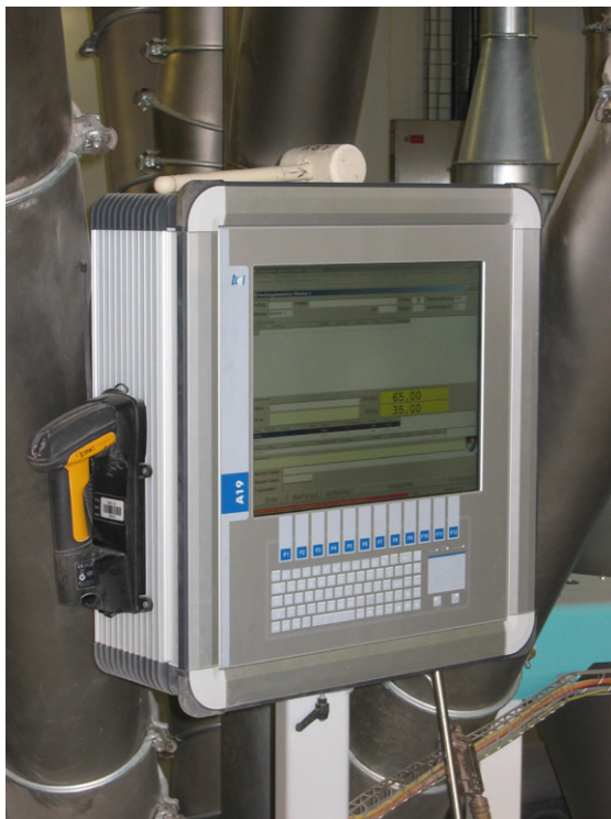
Abb. 2: Vor-Ort Bedienstation eines Leitsystems für den Verpackungsbereich (Quelle: Aurora Mühle Hamburg GmbH, Eckelmann AG)
