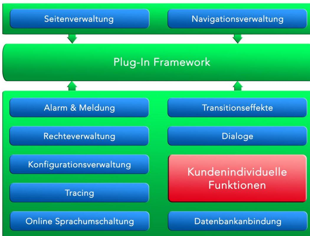
Abb 5: Plug-in-Architektur von E°Tools HMI (Bild: Eckelmann AG)
