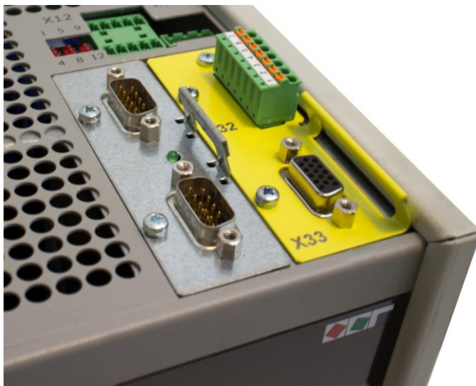
Abb. 4: Einschubmodul mit sicherem Stillstandwächter (Foto: Ferrocontrol)
