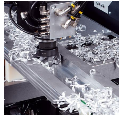
Abb. 1: Stabbearbeitungszentrum SBZ140 mit Werkzeugspindel beim Schlichtvorgang (Fotos elumatec AG)
