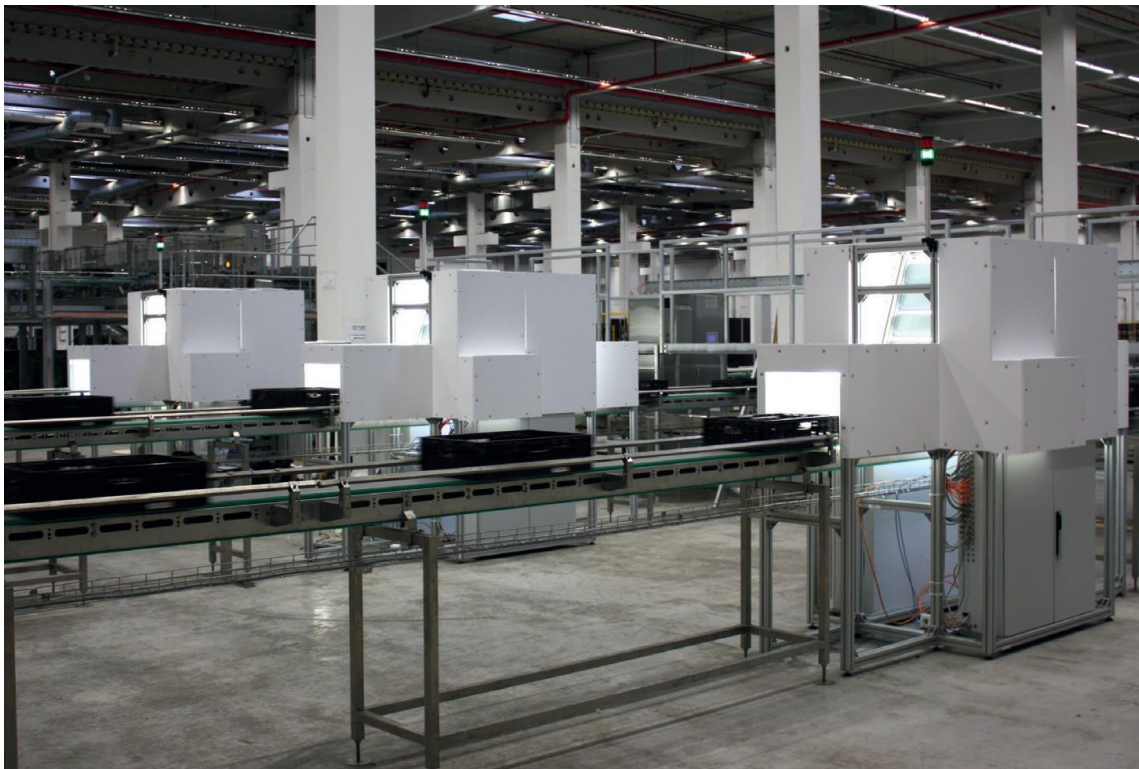
Abb. 1: E°CON-TROL von Eckelmann erkennt zuverlässig Verschmutzungen, Gebrauchsspuren und sogar strukturelle Mängel wie Ausbrüche oder Verformungen. Die kompakten Inspektionstunnel lassen sich in jede Behälterförderanlage einfach einbinden. (Foto: Eckelmann AG)
