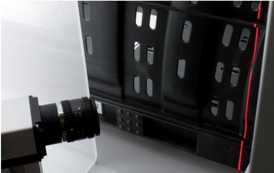
Abb. 6: Eine Kamera beobachtet die Linienprojektion im Inspektionstunnel (Foto: Eckelmann AG)
