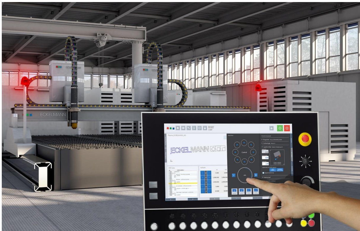
Abb. 1: Bedienung der virtuellen Brennschneidmaschine über das neue Cutting-HMI der Eckelmann AG (Foto: Eckelmann AG)
