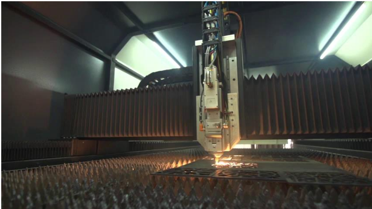
Abb. 5: Blick in die komplett eingehauste Maschine: Hochdynamisches XYZ-Positioniersystem mit Laserschneidkopf (Foto: Accumech)
