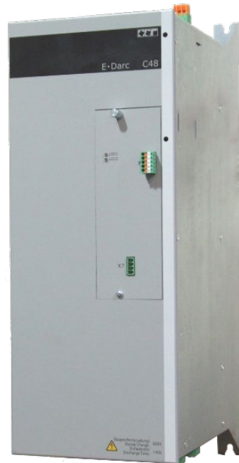
Abb. 3: E°Darc C48 Antriebsregler für den Betrieb von schnell drehenden Synchron- und Asynchronmotoren, z.B. für Spindeltriebe. Der Regler liefert einen Ausgangsnennstrom von I_{eff} = 48 A und einen Ausgangsspitzenstrom von I_{max} (eff) = 75 A (für 10 Sekunden bei einer Schaltfrequenz von 8 kHz) (Foto: Eckelmann FCS)
