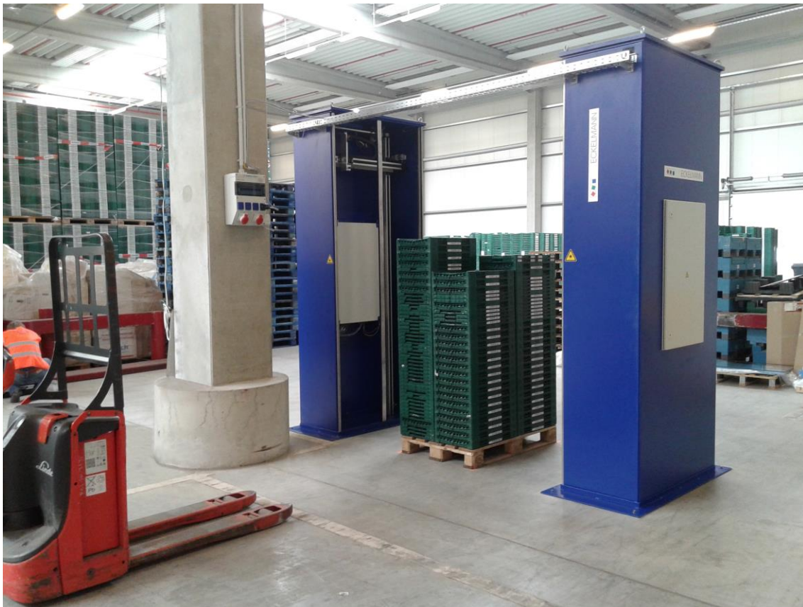
Abb. 2: Die Transportgebände können wie im Bild manuell per Hubwagen oder Gabelstapler ein- und ausgefördert werden oder optional automatisch über die Palettenfördertechnik.
