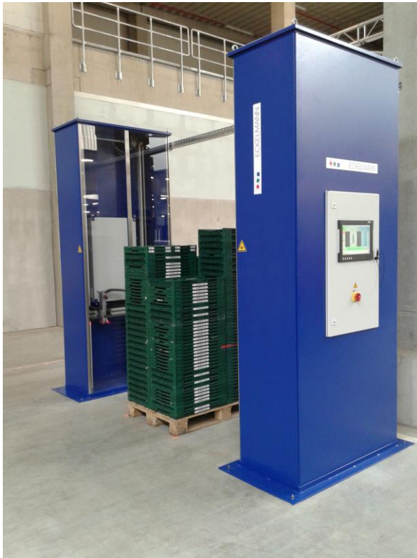
Abb. 1: E°CON-FIRM liest 1D- oder 2D-Codes von mehreren hundert auf einer Europalette gestapelten Mehrwegbehältern in wenigen Sekunden.
