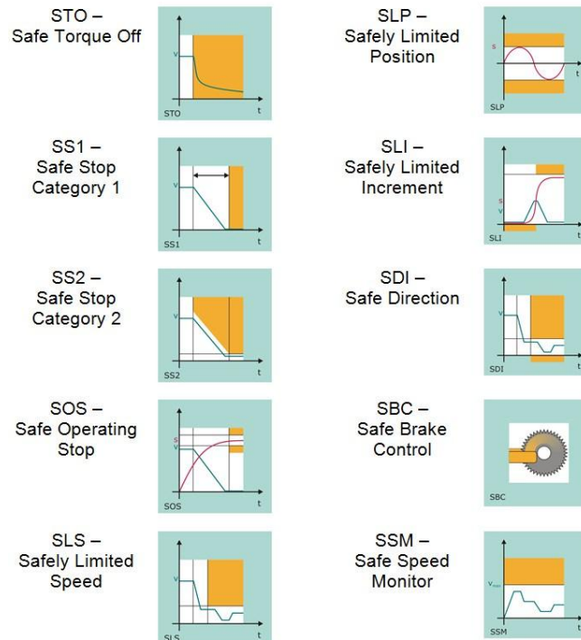
Bild 3: Die Sicherheitsfunktionen des E°Darc C (Grafik: Ferrocontrol)
